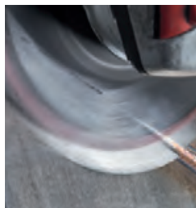
...Schleifen und Finish in einem Arbeitsschritt.
