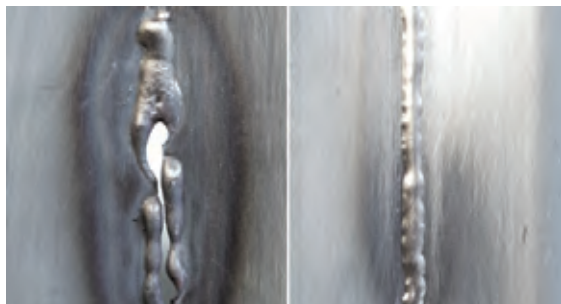
Ideal für Abschnittreparaturen mit MIG-Löt-Nähten
